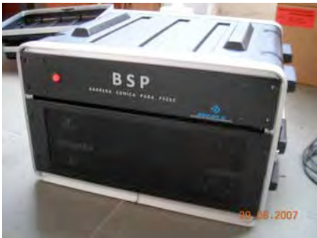
Generador de señal y amplificador BSP.
